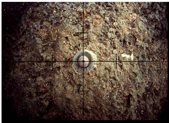
Mynd 6. Vanda skal uppstillu mælitækja þannig að þrjúkross sé nákvæmlega yfir merki.
